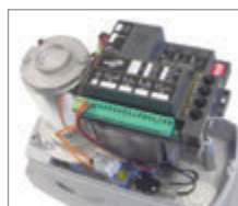
Centrala sterująca zasilana napięciem 24V
